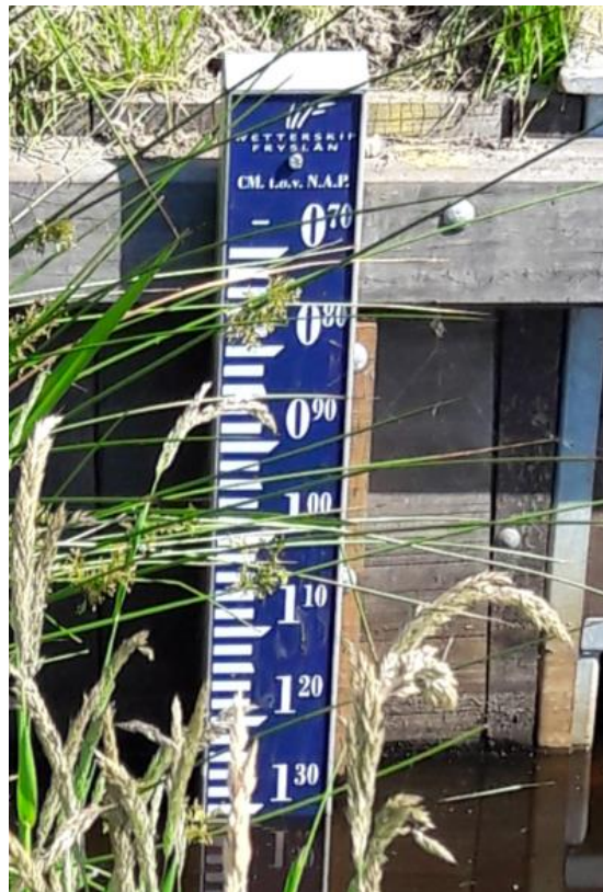
Figuur 5. Geplaatste peilschaal bij de afzonderlijke proefpercelen
